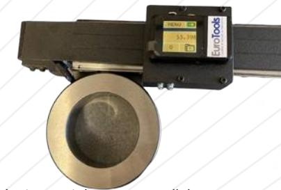
Instrument de mesure radiale
