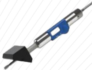
Multical Digital spécifique client pour le contrôle des trous taraudés obliques.
