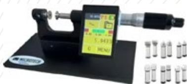
Mini-banc à butée micrométrique doté d'un grand écran tactile couleur avec un bargraph pour les tolérances définies par le client.
