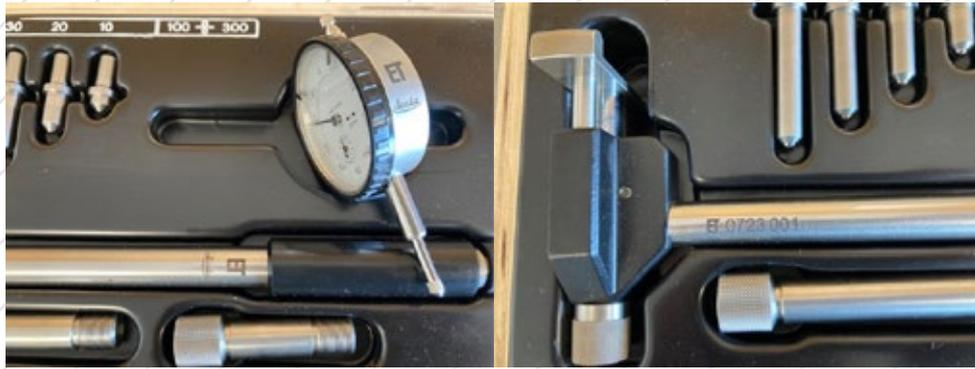
Pistolet alésométrique pour le contrôle d'axe de roue avec tête à 3 points de contacts  $\varnothing 100$  à 125mm et 125-150mm
