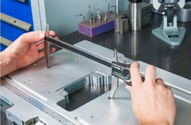
Alésomètre IMICRO – Mesure intérieure de diamètres d'alésage traversant ou borgne en version mécanique ou digitale
