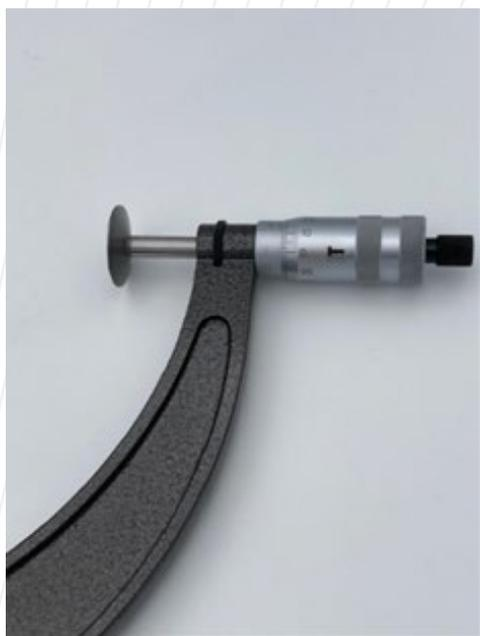
Micromètre d'extérieur à col de cygne avec disque à plateau (plein) pour mesure sur dentures
