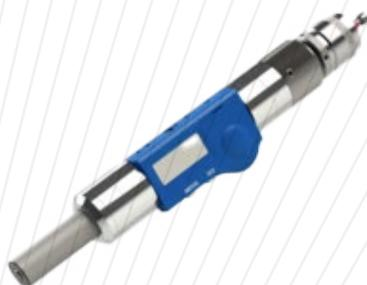
Multical Digital avec une force de mesure constante. Différentes forces de mesure sont réalisées par couplage à friction réglable.
