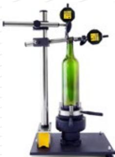
Ex. : Banc de contrôle dimensionnel de forme pour bouteille en verre
