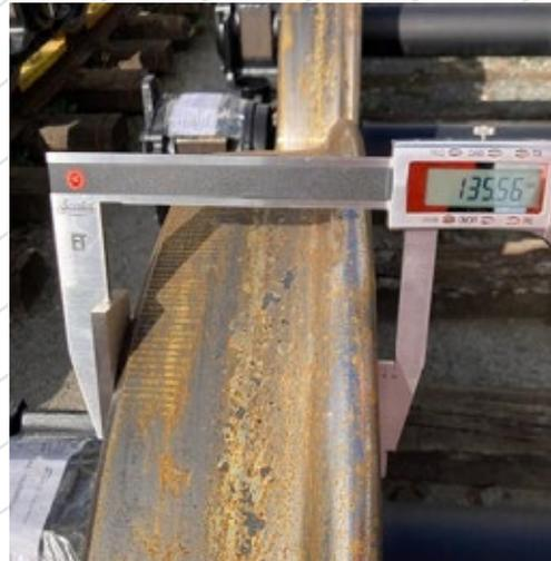
Dispositif de mesure rapide de l'usure des plaques Mn sur boîtes d'essieux
