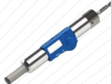
MultiCal Digital équipé d'un adaptateur hexagonal. Le tampon fileté GO peut être entraîné en option au moyen de l'adaptateur hexagonal.
