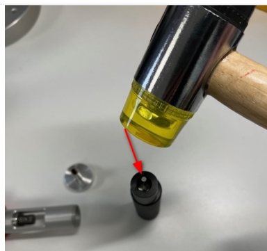
Photo 5. Insérer la pige puis taper dessus avec un marteau dédié pour expulser l'embout.
