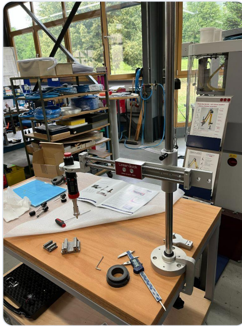
OmniTURN 1-18 digital EVO monté sur bras articulé Linear-Quick — utilisation ergonomique en environnement industriel
