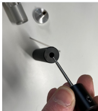
Photo 4. Placer l'accouplement avec l'embout fileté dans le cylindre.
