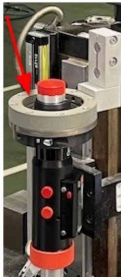
Bague rotative sur bras articulé Linear-Quick — utilisation ergonomique sans la contrainte d'inclinaison possible (évite d'abîmer l'embout fileté)
