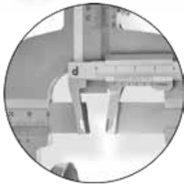
Appareil de mesure des boudins avec lecture directe de l'épaisseur des boudins pour les boudins plats (tramway) Sh 10 - 30, Sd 15 - 0 - 15, Rd 15 - 0 - 15, Rb 0 - 45 (Réf : 261.310)
