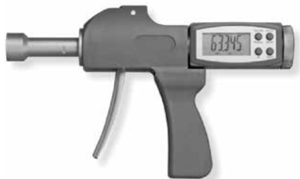
Micromètre d'intérieur à trois points avec poignée pistolet, deux têtes de mesure et bague de réglage, précision 0,001 mm, précision de 0,004 mm pour la mesure du diamètre intérieur des roulements à billes des essieux (Réf : 261.641)
